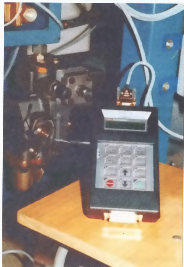
Rys. 2. Zastosowanie przyrządu HMG 2020 do diagnostyki pompy hydraulicznej typu A4VSO40DRG
