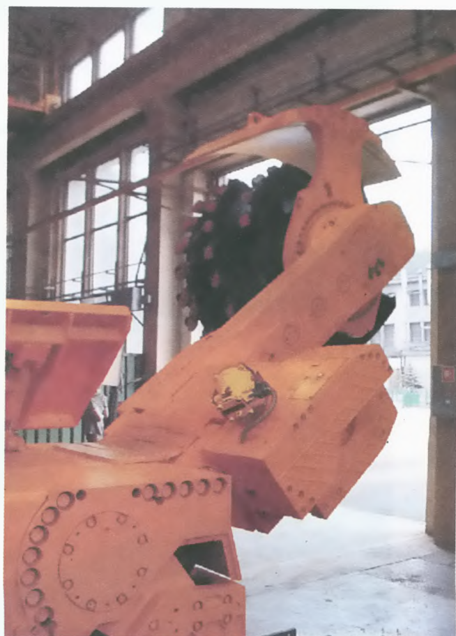
Rys.3. Ramię R-300 z organem o średnicy 1800 mm i głębokości zabioru 1000 mm
