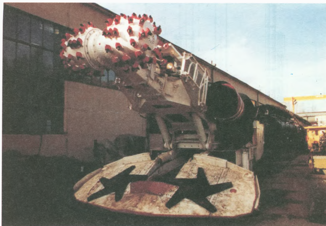
Rys.1. Widok kompleksu chodnikowego z kombajnem KR-150z
