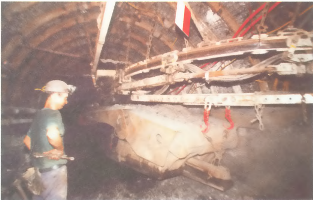
Rys.13. Transport sekcji obudowy zmechanizowanej za pomocą zestawu transportowego
