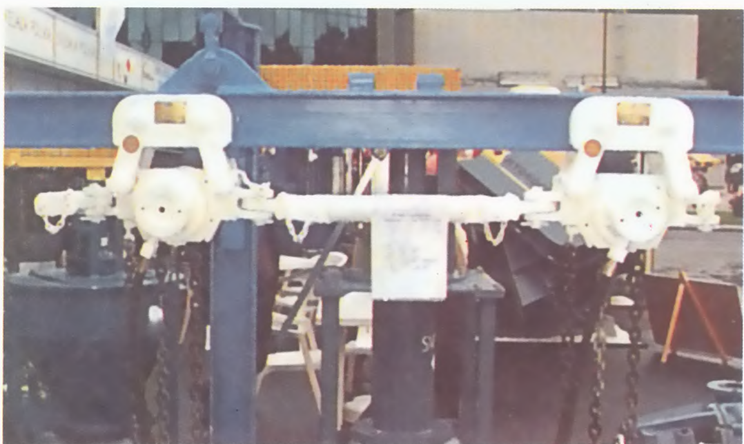
Rys.8. Widok wciągników przejezdnych transportowych WPT
