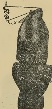
Rys. 5. Prawidłowo wyostrzony raczek
