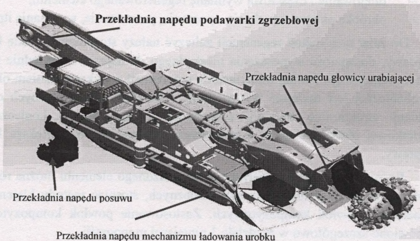
Rys. 2.3. Usytuowanie przekładni zębatych w kombajnie chodnikowym [39]
