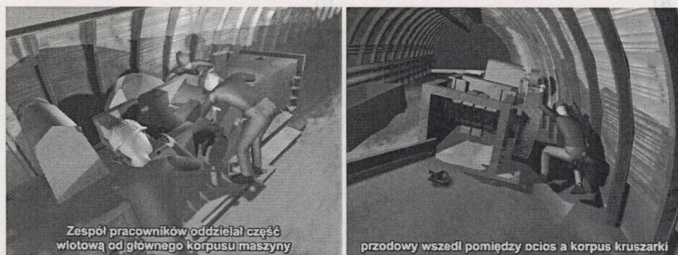
Rys.3.20. Wypadek spowodowany utratą stateczności przez częściowo zdemontowaną kruszarkę
