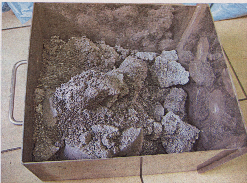
Rys.6.4. Próba nie nadająca się do oznaczenia wskaźnika reakcyjności
