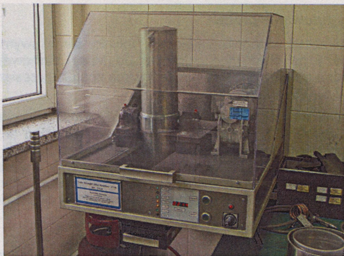
Rys.6.2. Urządzenie do bębnowania próbki koksu po badaniu reakcyjności
