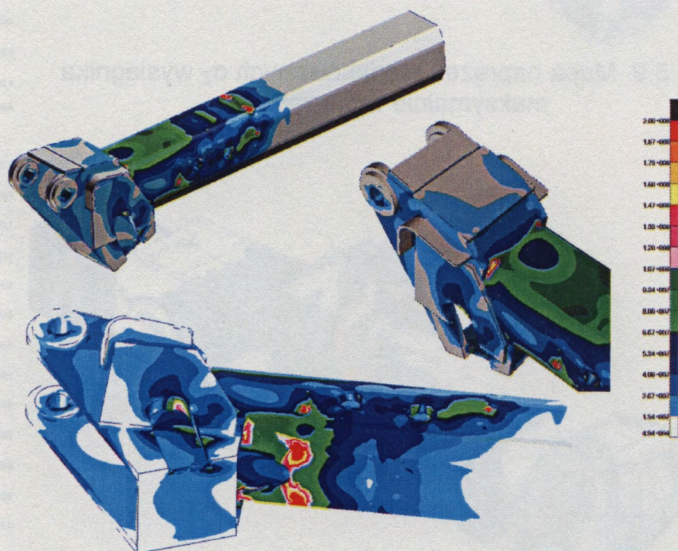
Rys.5.12. Mapa naprężeń zredukowanych \sigma_z ramienia wewnętrznego (wysięgnik całkowicie zsunięty)
