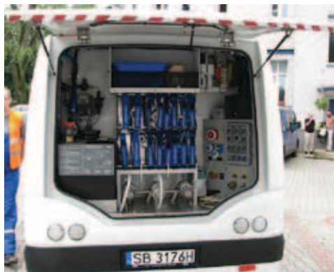
Rysunek 59. Widok nowoczesnej mobilnej stacji dezynfekcji wody stosowanej przez AQUA S.A. do awaryjnej dezynfekcji wody na końcówkach sieci wodociągowej oraz dezynfekcji odcinków nowobudowanej i remontowanej sieci wodociągowej oraz instalacji wodociągowych, w tym ciepłej wody użytkowej.
