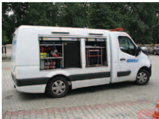
Rysunek 59. Widok nowoczesnej mobilnej stacji dezynfekcji wody stosowanej przez AQUA S.A. do awaryjnej dezynfekcji wody na końcówkach sieci wodociągowej oraz dezynfekcji odcinków nowobudowanej i remontowanej sieci wodociągowej oraz instalacji wodociągowych, w tym ciepłej wody użytkowej.
