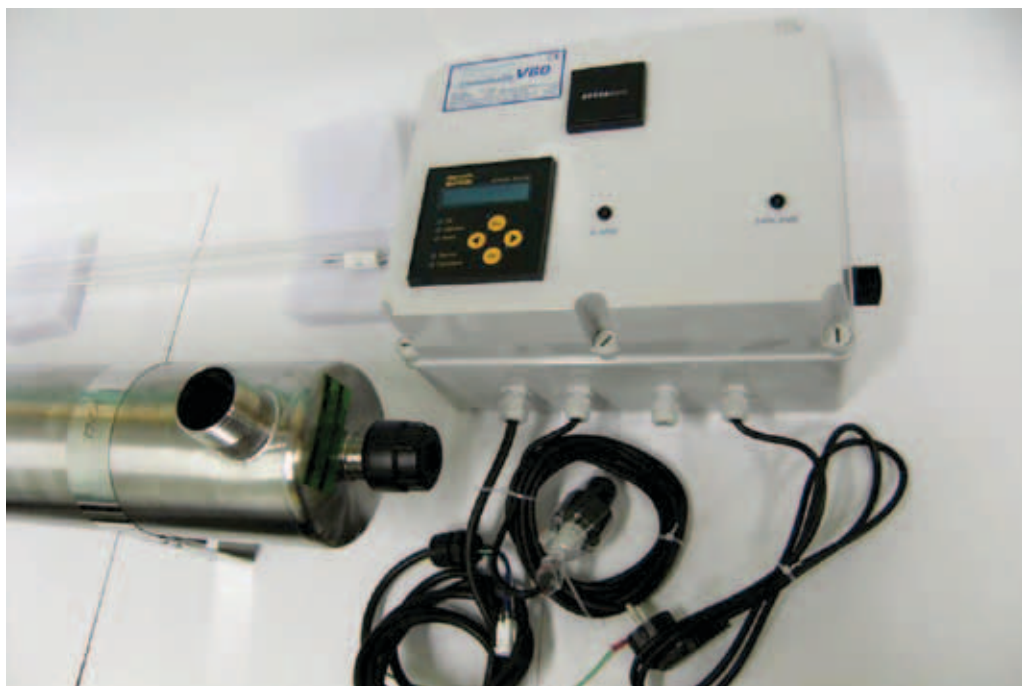
Rysunek 63. Bakteriobójcza lampa UV typu UVC-02 firmy TMA zastosowana w 2013 r. do dezynfekcji wody wypływającej ze źródła Walczok [źródło: materiały archiwalne AQUA S.A.].
