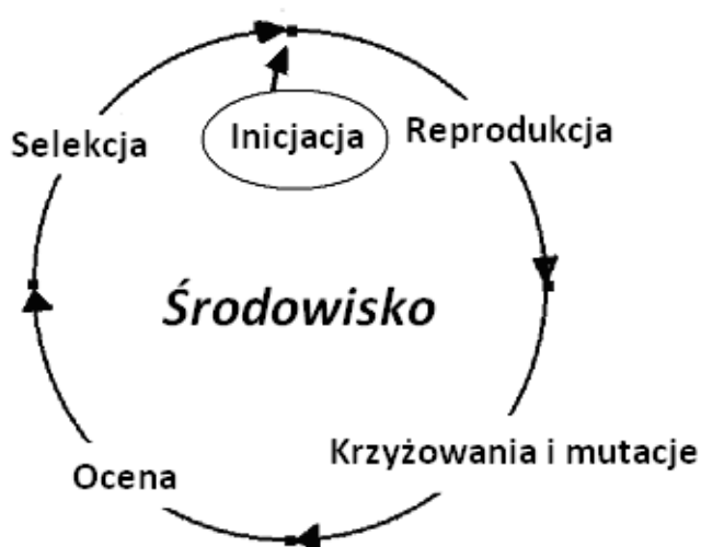
Rys. 1. Schemat algorytmu ewolucyjnego
