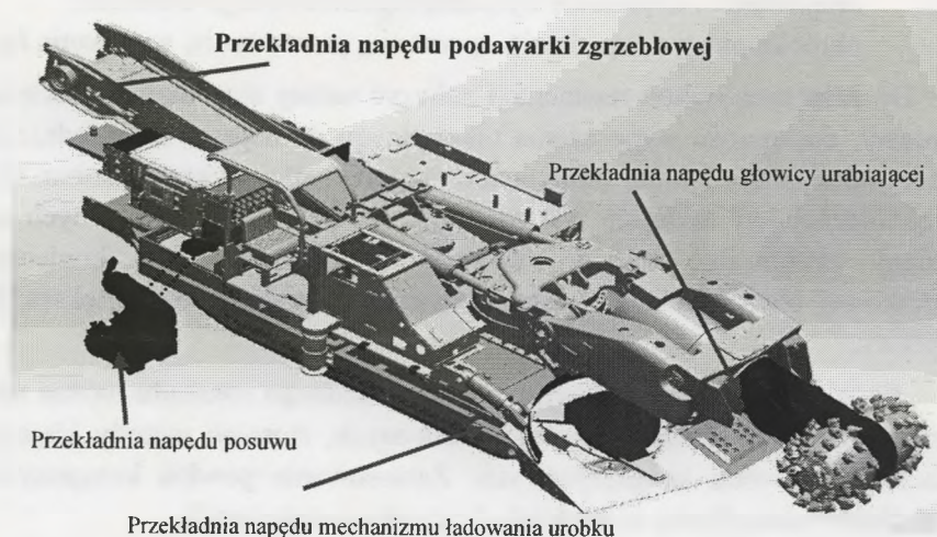
Rys. 2.3. Usytuowanie przekładni zębatych w kombajnie chodnikowym [39]
