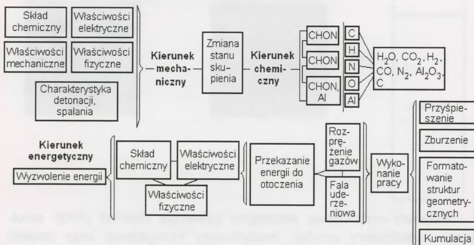
Rys.34. Przemiany energetyczne w MW [171]
