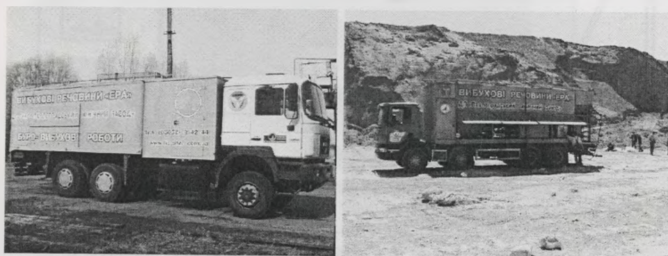
Rys.48. Samochody z urządzeniami mieszalniczo-załadowniczymi typu SMS K-8/7 i UMS-11 [157]
