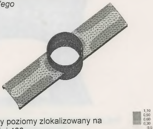
Rys.22. Wlot dwustronny symetryczny nachylony zlokalizowany na założonej głębokości 800 m, mapa naprężeń zredukowanych według hipotezy Hubera-Misesa-Hencky'ego
