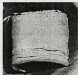
Rys.20. Konstrukcyjne rozwiązanie „dzwonków” reaktora WK-50 (a) i charakter pęknięć ujawnionych podczas kontroli (b)
