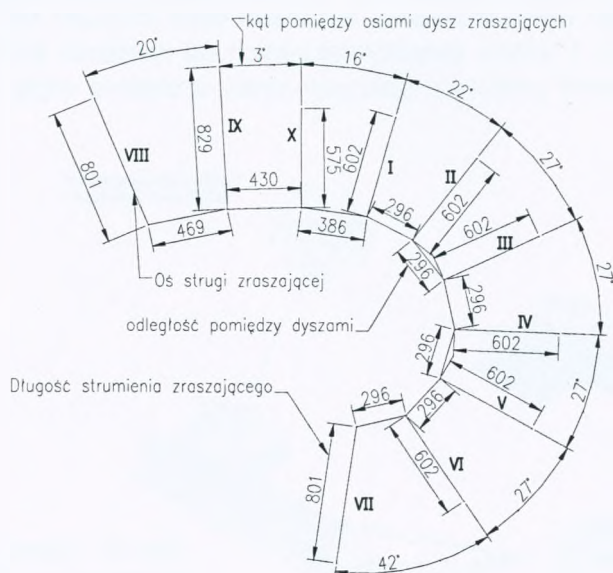
Rys.20. Strefa zraszania zewnętrznego mgłą powietrzno-wodną organu urabiającego \phi 1600 mm atakującego z ładowarką z ramienia R-200 N
