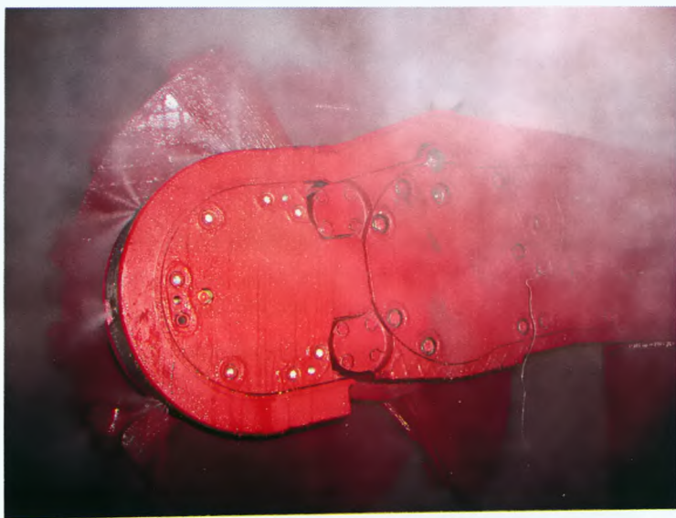
Rys.42. Ramię kombajnu KSW 460 NE z instalacją zraszania powietrzno-wodnego
