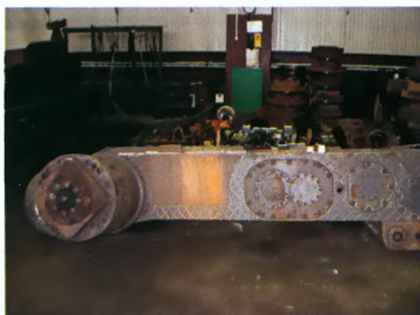
Rys.55. Ramię R-200 z zabudowanymi bateriami zraszającymi
