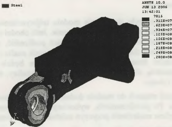
Rys.10. Naprężenie określone za pomocą ANSYS
