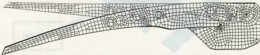
Rys.6. Postać drgań własnych stropnicy przy pierwszej częstotliwości własnej, wynoszącej 32,6 Hz
