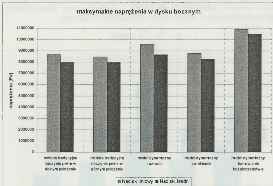
Rys.6.21. Maksymalne naprężenia w dysku bocznym w odniesieniu do modelowania obciążeń linopędni za pomocą nacisków średnich i liniowych
