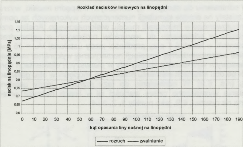
Rys.6.10. Rozkład nacisków liniowych na linopędnę w zależności od kąta opasania liny w odniesieniu do dwóch stanów obciążeń wyznaczonych za pomocą modelu wielomasowego
