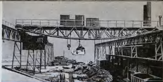
Suwnica z uchwytem elektromagnetycznym i hakiem
