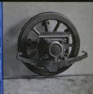
Złożone części zawieszenia „Peckham” dla wozów tramwajowych
