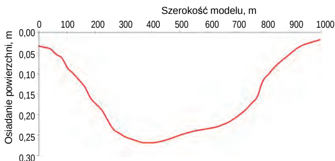
Rys. 7.2.10. Obniżenia powierzchni terenu wzdłuż linii profilu 1–50 w modelu numerycznym po zasymulowaniu eksploatacji chodnikami w filarze ochronnym
