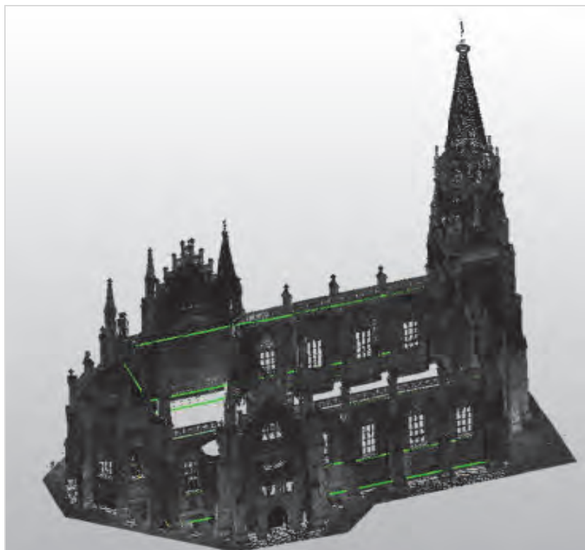
Rys. 9.4.7. Zeskanowana bryła kościoła z zaznaczeniem linii do wyznaczenia krzywizn
