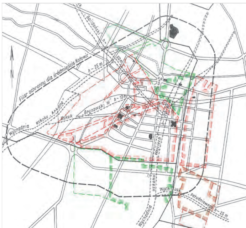
Rys. 4.4.2. Zakres eksploatacji dokonanej w ramach fazy 1 etapu I (Borecki, 1980)
