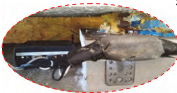
Fot. 9.3.3. Pochyłomierz elektroniczny MMS zainstalowany na wiadukcie drogowym i wyniki zmian nachylenia (Jaśkowski, 2018)
