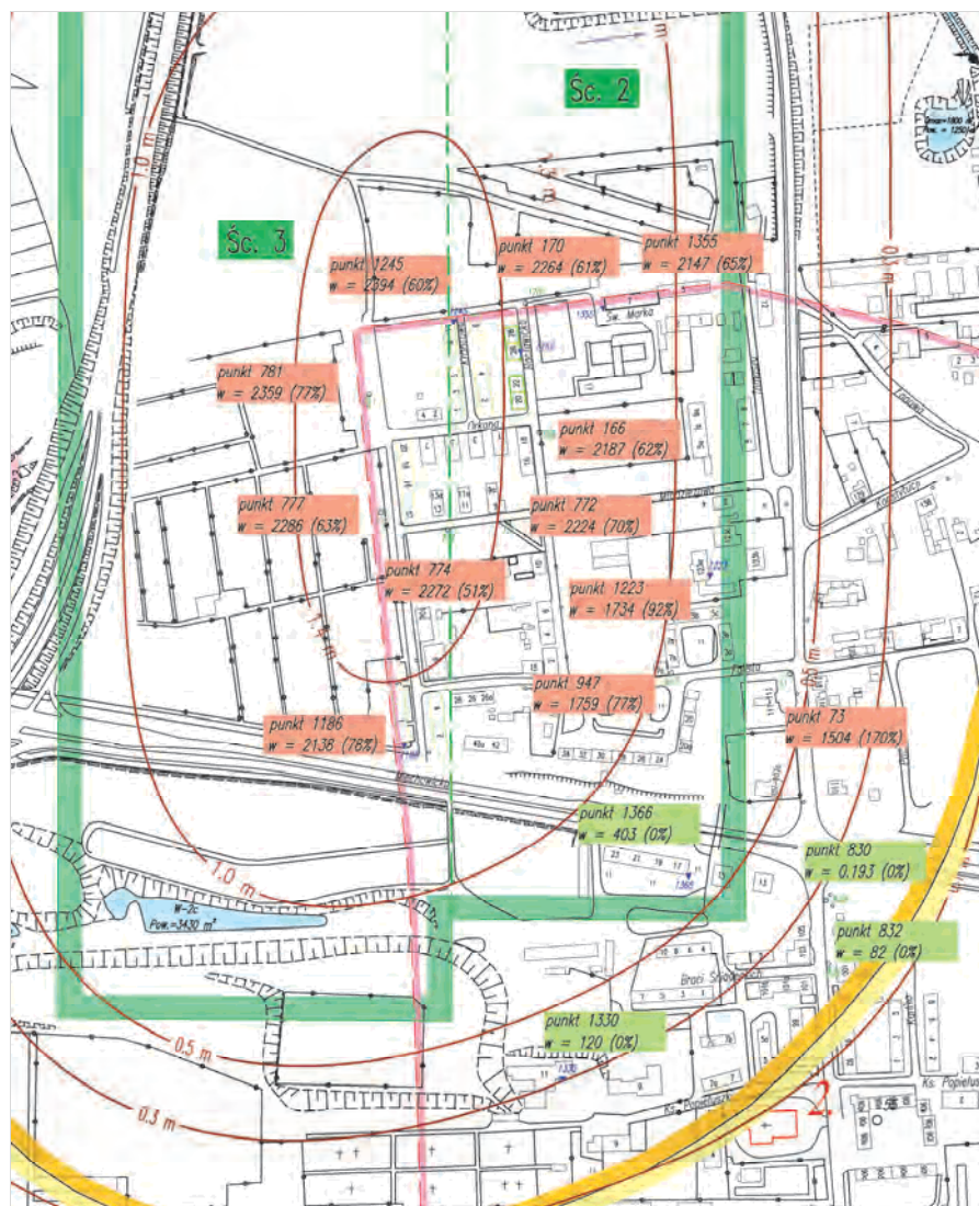
Rys. 4.4.18. Prognozowane izolinie obniżeń i kategorie terenu górniczego oraz wartości obniżeń pomierzone w wybranych punktach (zabudowa według stanu na 31.12.2016 r. po wyburzeniach segmentów)
