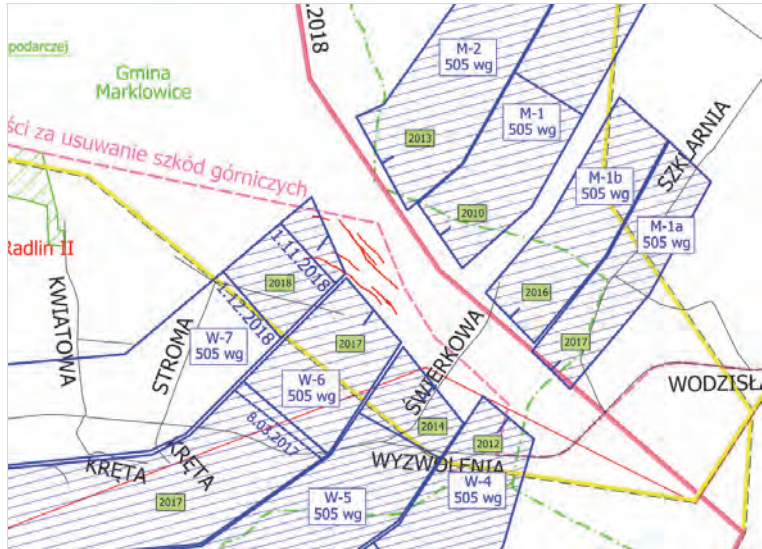
Rys. 4.6.5. Sytuacja górnicza powodująca powstanie na powierzchni LNPP przedstawionej na fotografii 4.6.3
