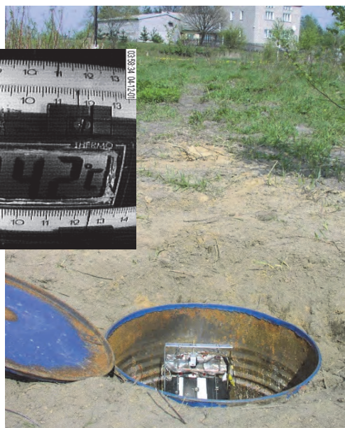
Fot. 9.3.4. Konstrukcje do pomiaru zmian długości baz pomiarowych na trzech odcinkach o różnej długości z wykorzystaniem do rejestracji systemu telemetrycznego z kamerą TV (Jaśkowski, 2018)
