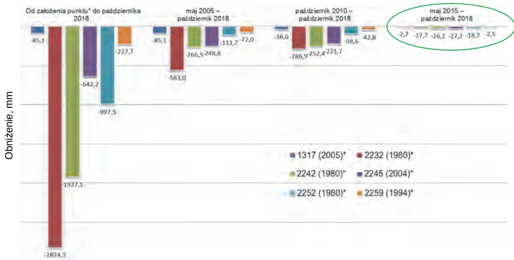
Rys. 4.4.12. Obniżenia punktów niwelacji precyzyjnej w latach 2000–2018 (Wagner, 2019)
