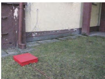
Fot. 9.3.5. Telemetryczny rezystancyjny system pomiarowy do wyznaczania odkształceń poziomych (Jaśkowski, 2018)
