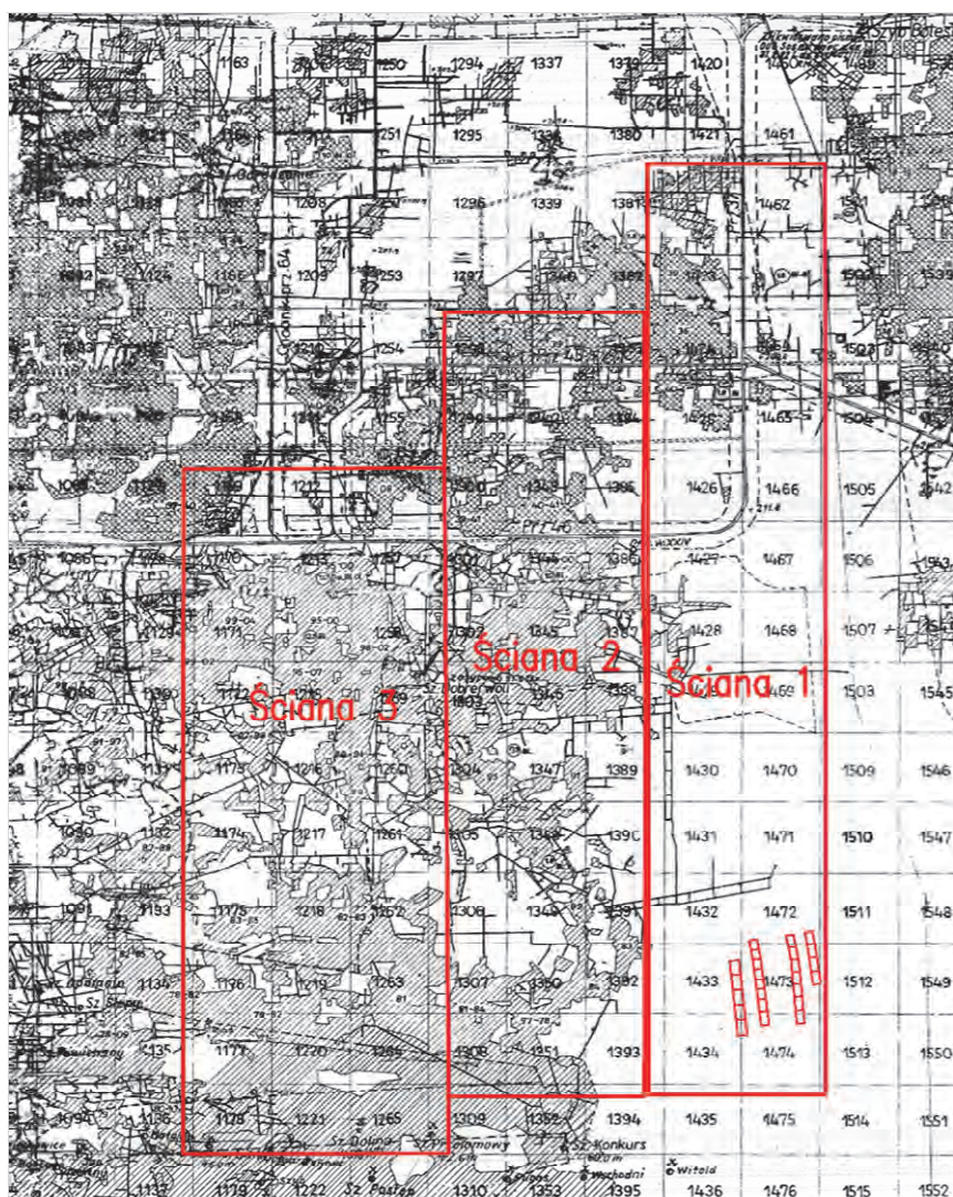
Rys. 4.4.16. Wycinek mapy z wyrobiskami górniczymi w złożu rudy, na którym zaznaczono kontur ścian nr 1–3 w pokładzie 504w.g. oraz wyburzone budynki przy ul. Pocztowej i Technicznej
