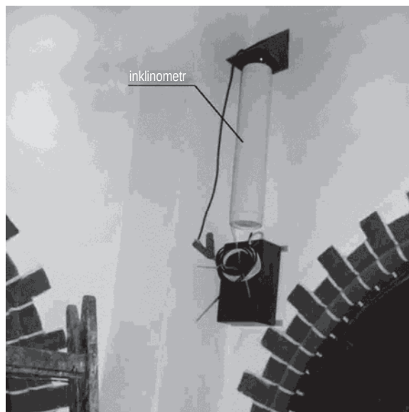
Rys. 9.2.2. Instalacja inklinometru w narożu wieży kościoła (Florkowska i Kanciruk, 2012)
