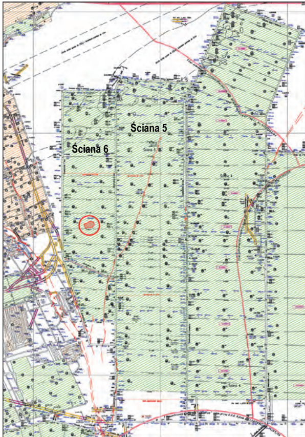
Rys. 4.4.20. Schemat eksploatacji ścianami 5 i 6 w pokładzie 503 w rejonie kościoła – a, opaska Ledwonia i geodezyjna sieć pomiarowa do badań deformacji – b
