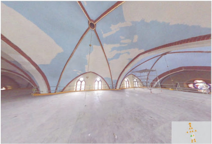
Rys. 9.4.9. Model 3D stropu kościoła – „wirtualny spacer” wewnątrz obiektu z możliwością oceny i pomiaru uszkodzeń stropu (autor: P. Gruchlik)
