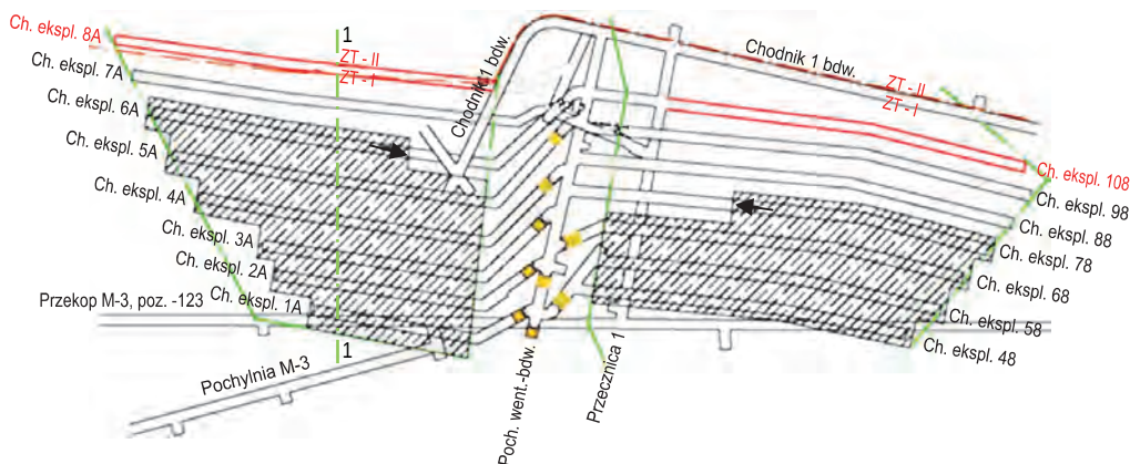
Rys. 4.5.15. Schemat i kolejność eksploatacji chodnikami systemem podbierkowym (Gajos, Urbaś i Lamot, 2005)
