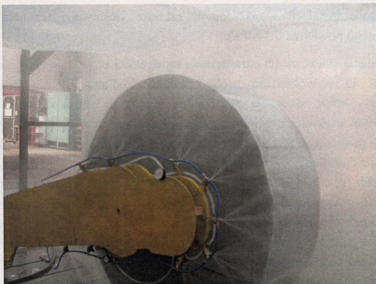
Rys. 5.5. Widok modelu (makiety) organu urabiającego z ramieniem i powietrzno-wodną instalacją zraszającą [66]
