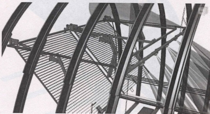
Rys. 7.3. Chodnikowa zapora przeciwpylowa według patentu PL 233913 B1 [10, 61, 104]
