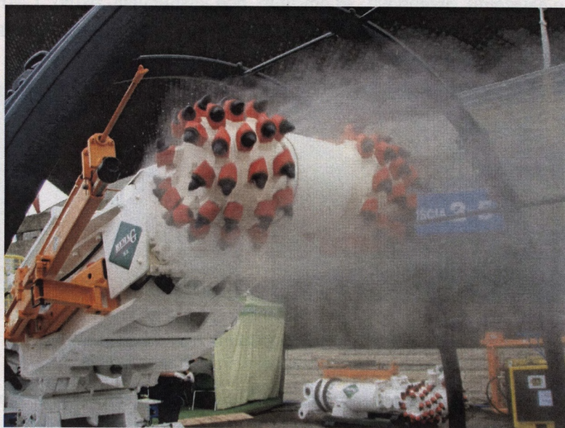
Rys. 6.5. Kurtyna powietrzno-wodna zabudowana na kombajnie R-130 [39]
