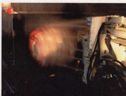
Rys. 6.4. Gaszenie płomieni gazowych z wykorzystaniem powietrzno-wodnej instalacji zraszającej: a) przed zagaszeniem, b) po zagaszeniu [39]
