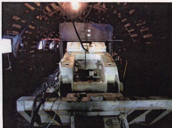
Rys. 6.2. Ramię kombajnu chodnikowego umieszczone na stanowisku badawczym [39]
