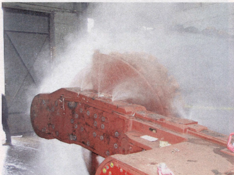
Rys. 5.11. Kombajn ścianowy KSW-460NE podczas testów instalacji zraszającej w KWK Pniówek [78]
