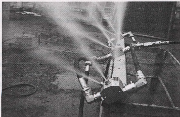
Rys. 8.7. Zraszacz systemu KOMAG podczas testów w ZG Sobieski [5]
