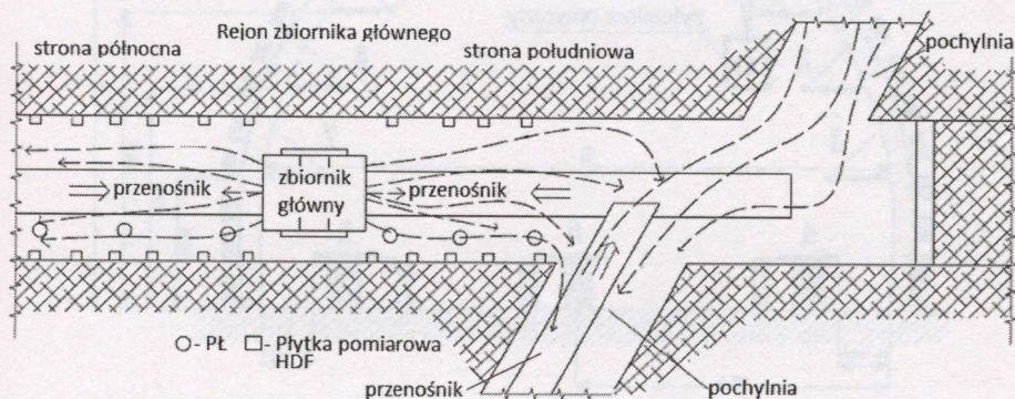
Rys. 9.10. Lokalizacja punktów pomiarowych w rejonie zbiornika [51]
