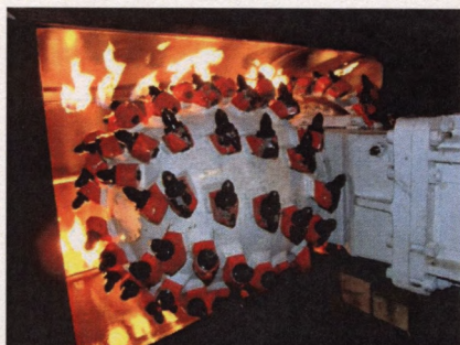
Rys. 6.4. Gaszenie płomieni gazowych z wykorzystaniem powietrzno-wodnej instalacji zraszającej: a) przed zagaszeniem, b) po zagaszeniu [39]
