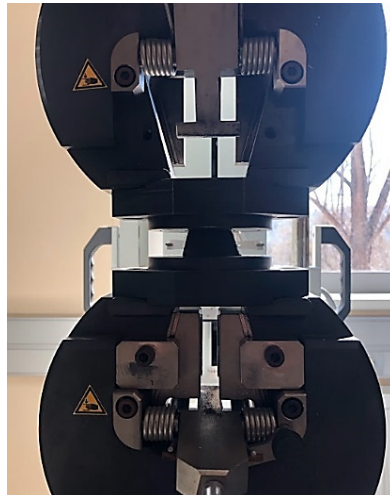
Fig. 5. Pressure test ( own research , ČSN EN 1015-11, 2020)
