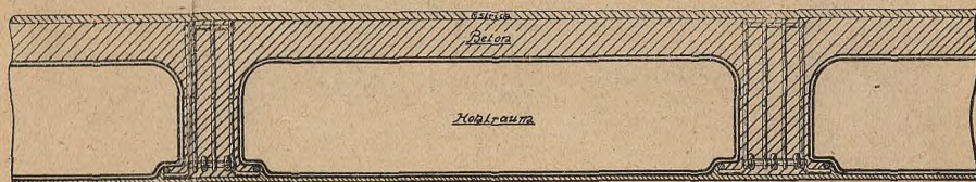
Querschnitt einer Massivdecke mit Betonfußboden.
