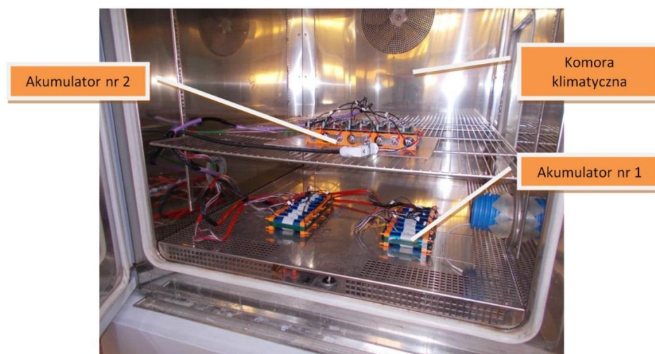
Rys. 7.34. Rozmieszczenie pakietów akumulatorowych w komorze klimatycznej. Akumulator nr 1 podłączony do systemu BMS z balansowaniem aktywnym metodą bateria do ogniwa. Akumulator nr 2 podłączony do systemu BMS z balansowaniem aktywnym metodą ogniwo do baterii
