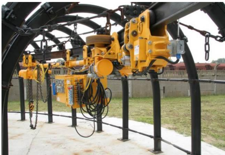
Rys. 9.2. Widok ogólny zawieszonego pojazdu akumulatorowego PCA-1
