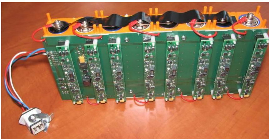
Rys. 7.2. System BMS zainstalowany na pakiecie ogniw
