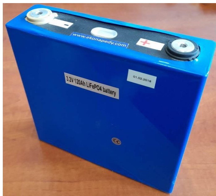
Rys. 9.4. Ogniwo \text{LiFePO}_4 120Ah (litowo-żelazowo-fosforanowe) o pojemności 120 Ah stosowane w podwieszanym ciągniku akumulatorowym PCA-1
