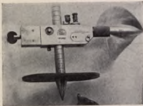
Przyrząd do mierzenia szybkości wody
